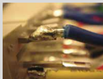
Ikke acceptabel lodning (manuel lodning)
